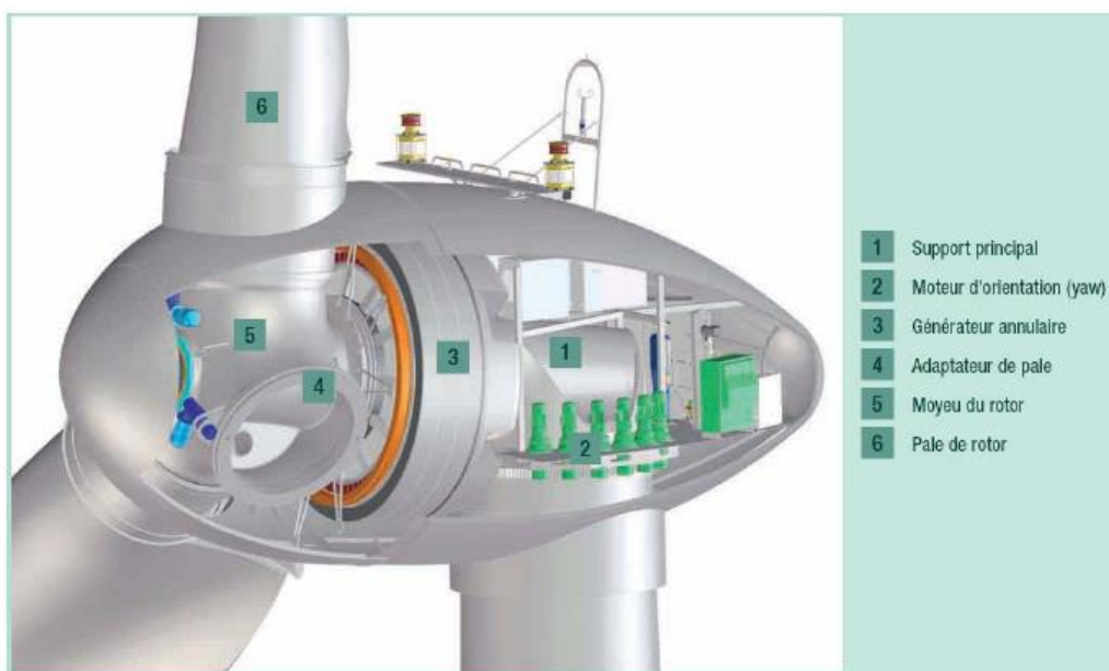
Figure 5 : Le dessin schématique de la nacelle (source : ENERCON)
