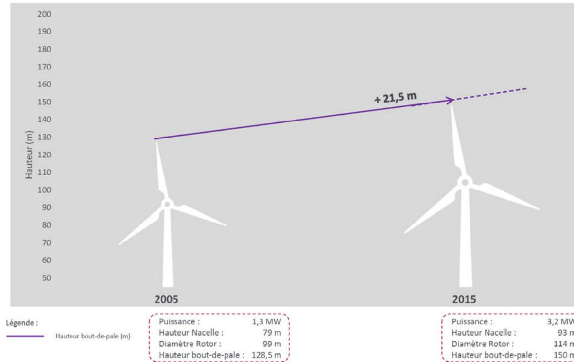
Figure 7 : Evolution de la technologie entre 2005 et 2015 (source : Bearing Point, 2016)
