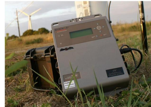
Figure 239 : Détecteur/enregistreur d'ultrasons SM3Bat de chez WildlifeAcoustics (source : Amikiro, 2017)
