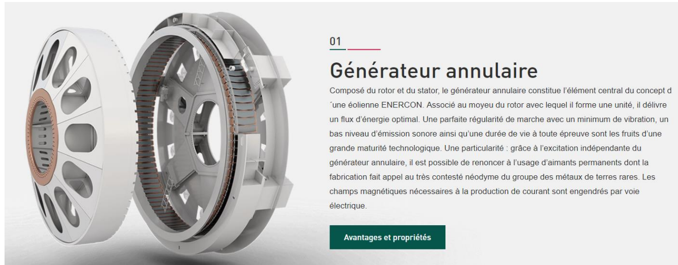
Figure 14 : Génératrice annulaire ENERCON
