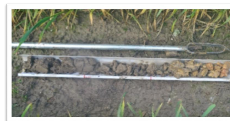
Figure 16 : exemple de carottage sur une profondeur de 120 cm
