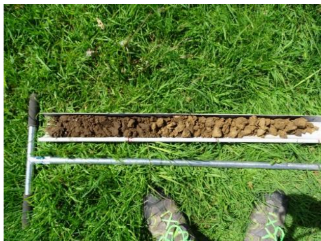
Figure 19 : Carotte de terre du sondage n°10 en zone prairiale
