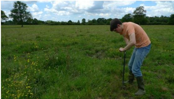
à l'aide d'une tarière pédologique. Cet outil rudimentaire permet de prélever de manière graduée des échantillons de sol pour y rechercher des traces d'oxydoréduction. Chaque prélèvement a été localisé, afin de permettre un report précis de ces derniers sur les fonds de carte.
