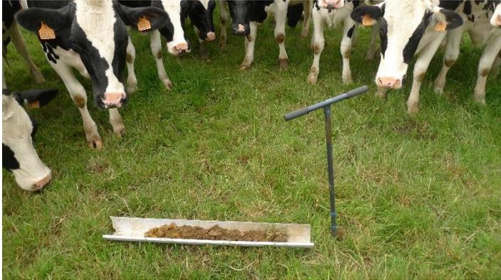
Sur le carottage du point de prélèvement 11, les premières traces d'oxydoréduction apparaissent vers 30 cm de profondeur, elles s'intensifient très nettement à partir de 45 cm.
