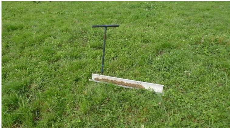
Sur le carottage du point de prélèvement 14, les traces d'oxydoréductions débutent vers 40 cm et s'intensifient fortement dès 50 cm.
