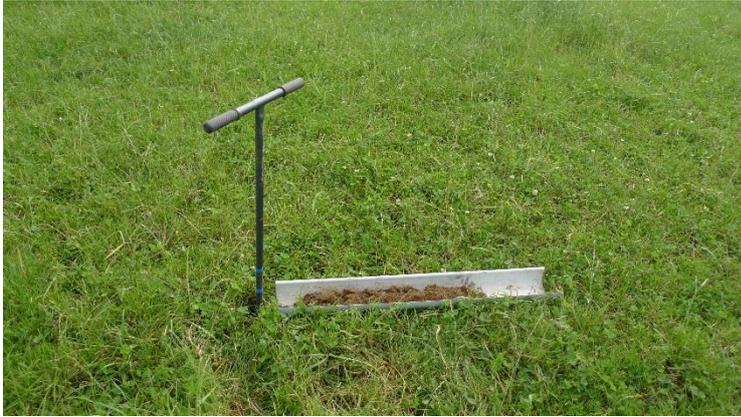
Sur le carottage du point de prélèvement 7, on ne retrouve aucune trace d'oxydoréduction à moins de 60 centimètres.
