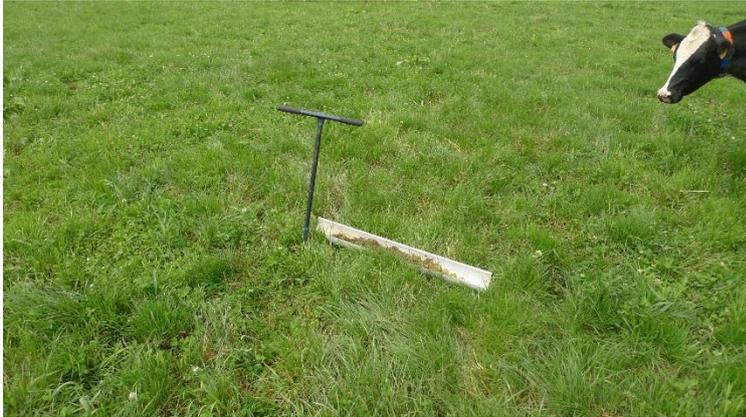
Sur le carottage du point de prélèvement 13, les traces d'oxydoréductions débutent vers 40 cm et s'intensifient fortement dès 50 cm.
