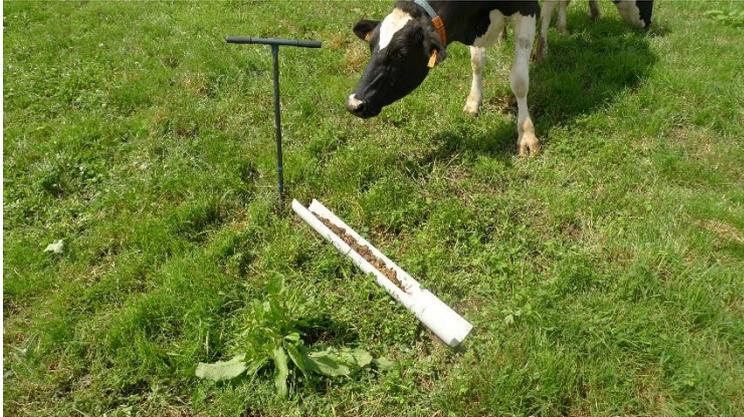
Sur le carottage du point de prélèvement 15, les traces d'oxydoréductions débutent dès 20 cm et s'intensifient fortement à partir de 40 cm.
