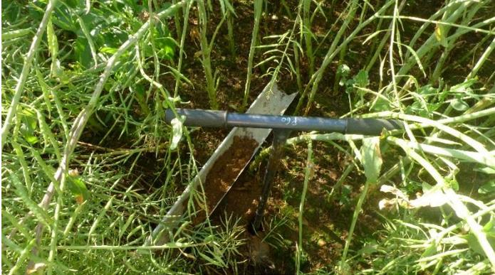
Sur le carottage du point de prélèvement 1, on ne retrouve aucune trace d'oxydoréduction jusqu'à 50 centimètres.
