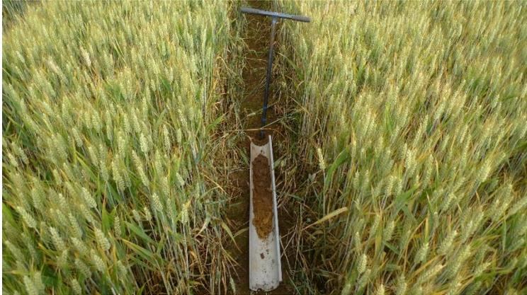
Sur le carottage du point de prélèvement 5, on ne retrouve aucune trace d'oxydoréduction à moins de 50 centimètres.
