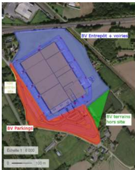
Schéma des bassins versants des eaux pluviales
