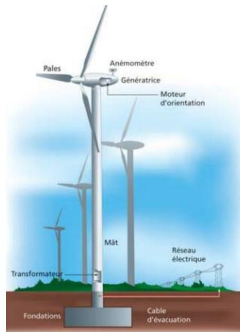
Figure 8 : Représentation schématique d'une éolienne (Source : EDF)
