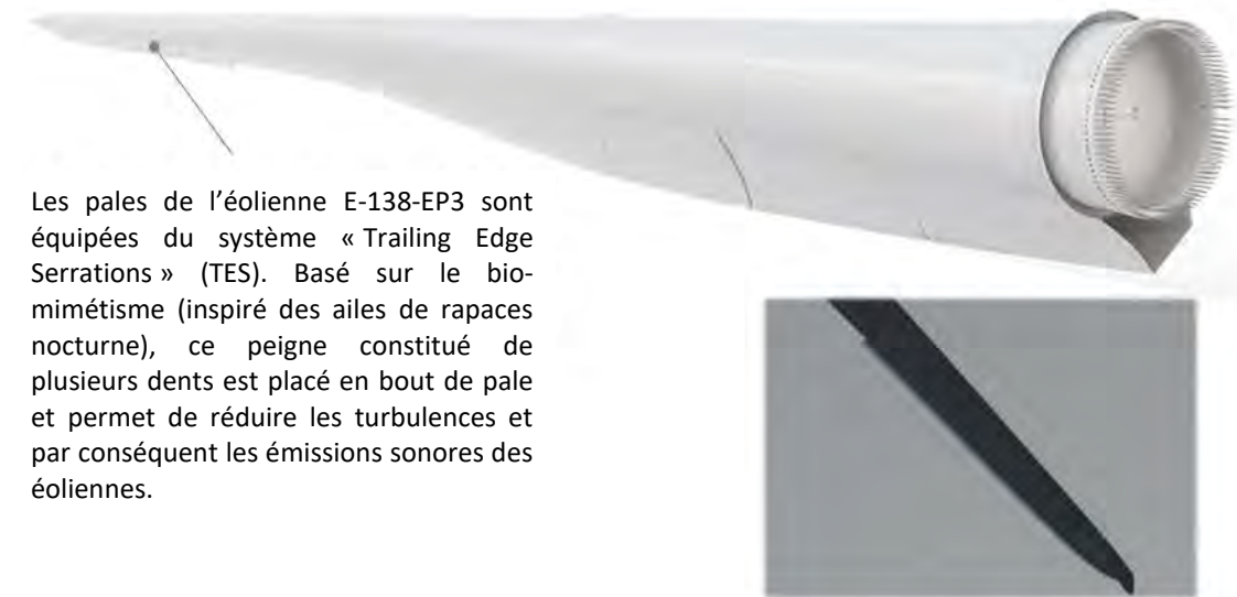
Figure 143 : Serrations installées sur les pales d'une éolienne ENERCON E-138-EP3
