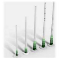
Mât            | Supporter la nacelle et le rotor                                                                                                                                         | Structure : 6 sections en acier<br>Diamètre de la base : 4,3 m<br>Hauteur du mât seul : 105,31 m
