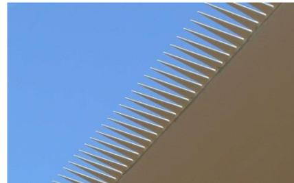
Photographies d'une pale dotée d'un système STE (peigne / dentelure)
