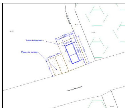
Figure 34 : Localisation du poste de livraison
