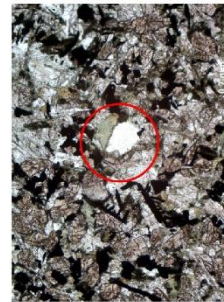
Echantillon CO4 (grossissement x 10) - à gauche en Ln, à droite en Lp - quartz et chlorite tardifs (au centre).
