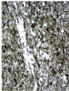
Echantillon CO5 (grossissement x 2.5) - à gauche en Ln, à droite en Lp – foliation à quartz (clair en Ln) +chlorite (verte en Ln) majoritaire.
