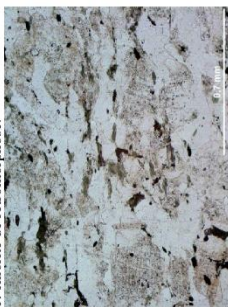
Echantillon CO2 (grossissement x 10) - à gauche en Ln, à droite en Lp – veines à carbonates et chlorite de rétroformation.
