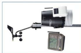
Fig. 4 : Station météorologique DAVIS Vantage Pro 2
