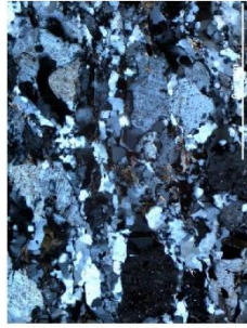
Echantillon CO2 (grossissement x 10) - à gauche en Ln, à droite en Lp – veines à carbonates et chlorite de rétroformation.
