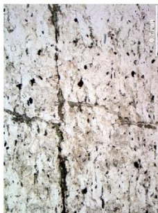
Echantillon CO2 (grossissement x 5) - à gauche en Ln, à droite en Lp – foliation à quartz+plg et veines à chlorite-carbonates.
