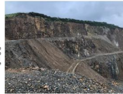
9035-front de taille Est - zone centrale à alternance acide/basique et niveaux gris + massifs de part et d'autre
