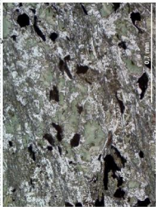
Echantillon CO5 (grossissement x 10) - à gauche en Ln, à droite en Lp – détail des associations à chlorite-actinote soulignant la foliation.
