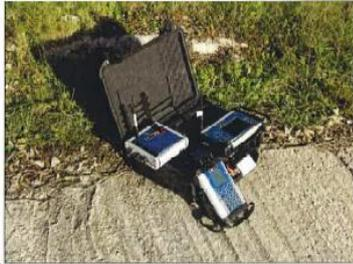
L'ensemble DTOPW : la DRB, la PU, le pilote de ligne et la clef de sécurité RFID
