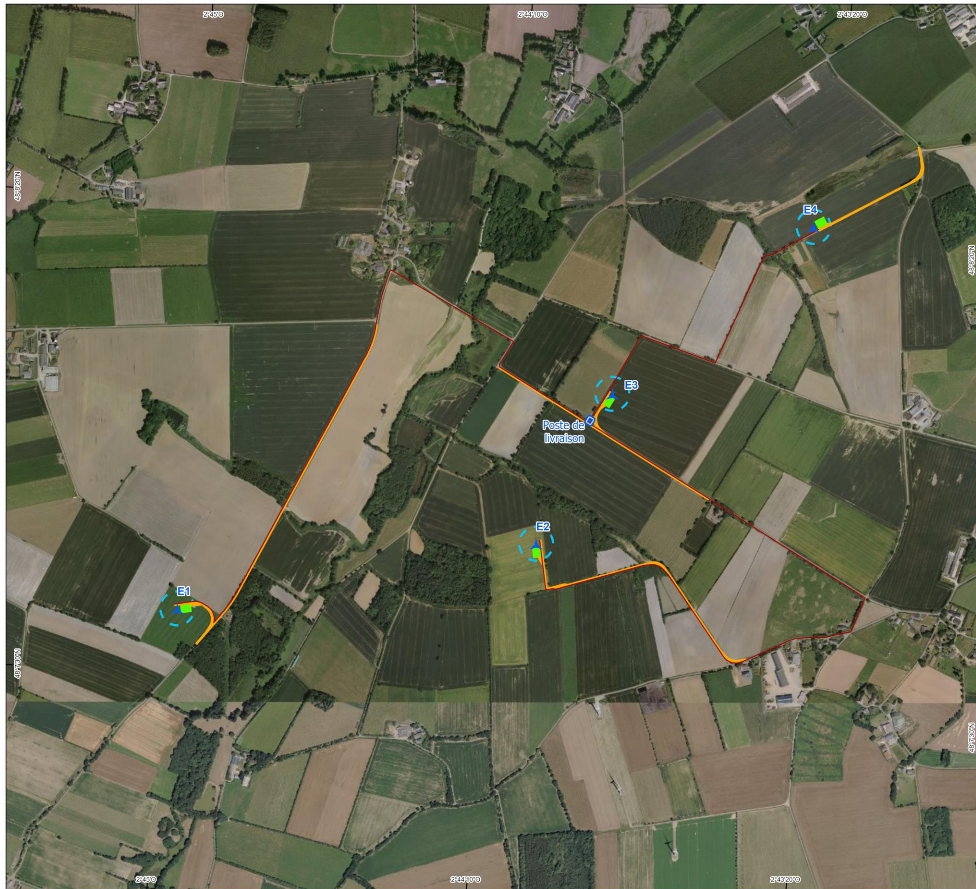
carte 7 localisation des voies d'accès et câblages inter éoliennes
