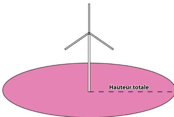
Figure 9 : zone d'effet / Effondrement de l'éolienne
