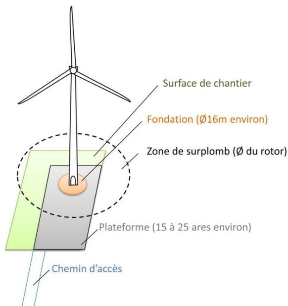
Figure 5 : Illustration des emprises au sol d'une éolienne
