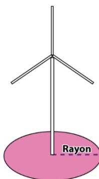
Figure 11 : zone d'effet / Chute d'éléments de l'éolienne
