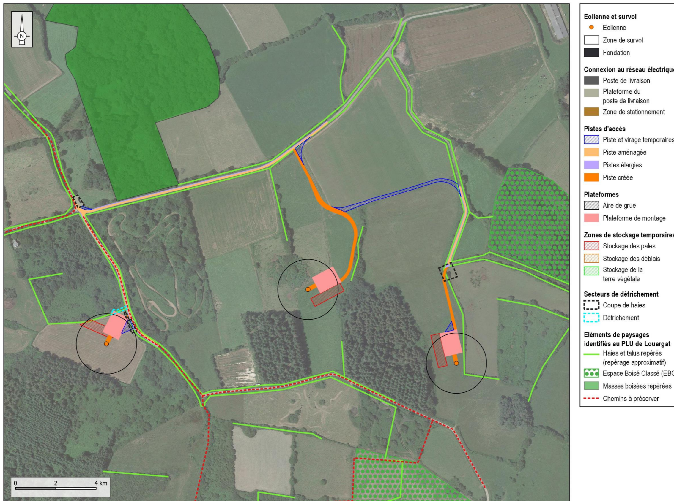
Plan de masse du projet vis-à-vis des éléments de paysage à préserver identifiés au PLU de Louargat
