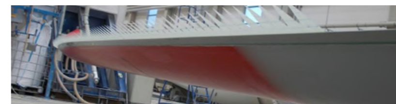
Photo 4 : Montage des peignes sur les pales d'une éolienne
