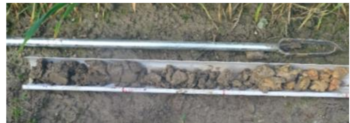
Photo 2 : Exemple de carottage sur une profondeur de 120 cm
