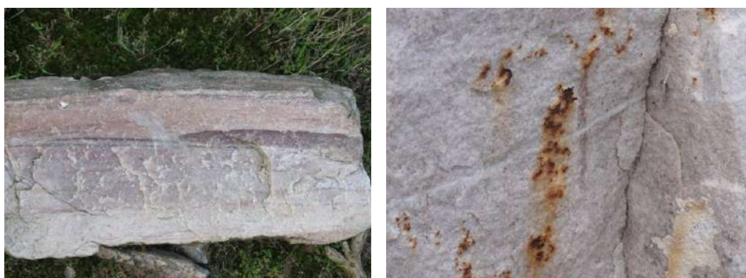
Fig. 10. Grès quartzite d'Erquy et concentration d'hématite dans le grès quartzite (source : vivarmor.over-blog.com )
