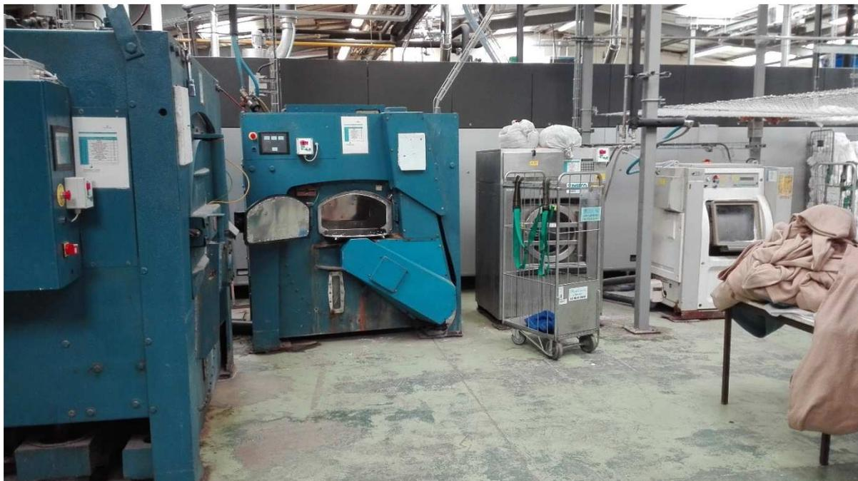
Figure 8 : les 4 laveuses et le tunnel de lavage au second plan
