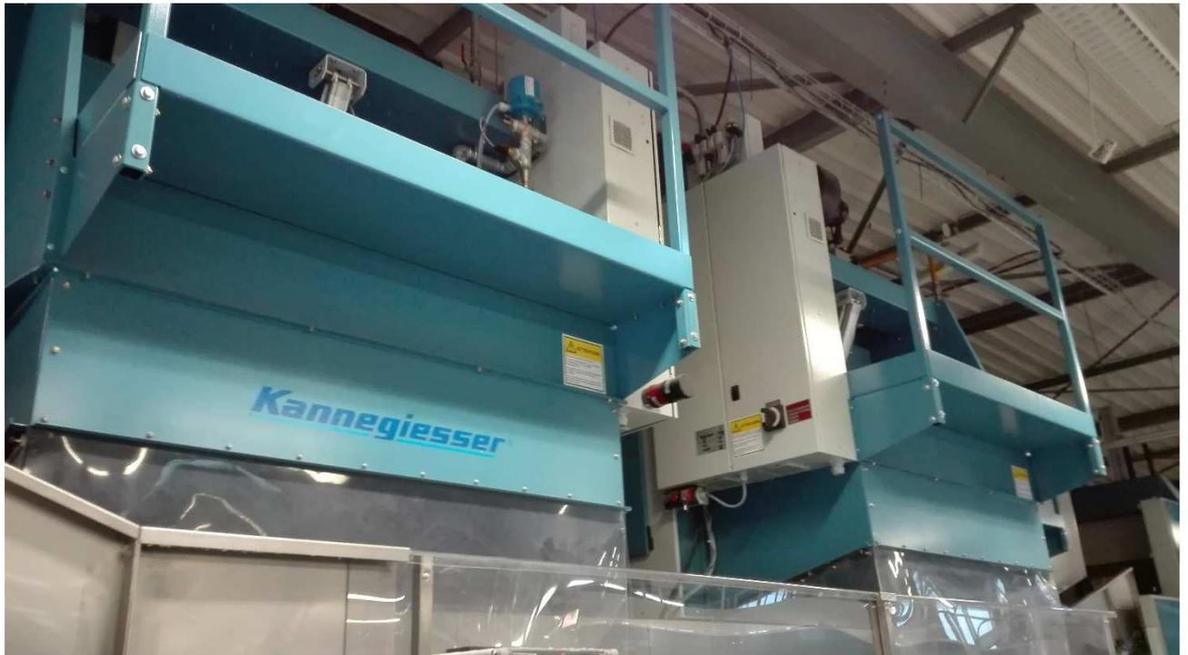
Figure 9 : séchoirs à sprinklers internes
