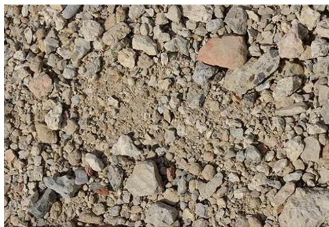
Figure 36 : Exemple de revêtement GNT 0/60
