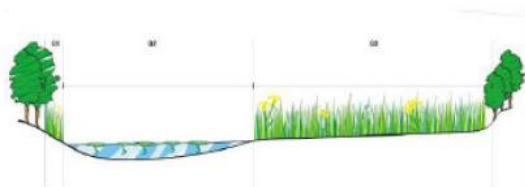
Figure 1 : Schéma de principe de la mare à créer en périphérie des emprises du projet
