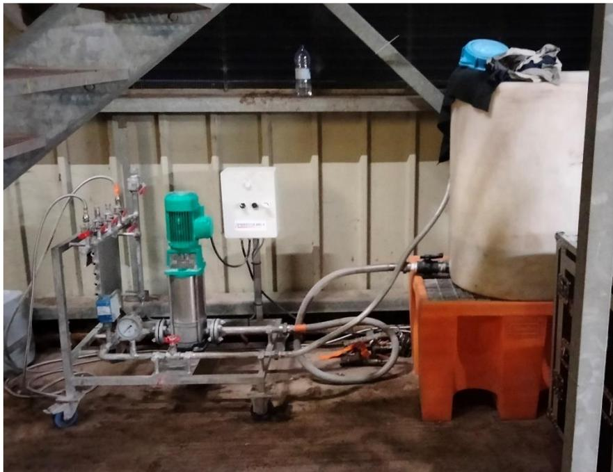
Figure 5 : Skid mobile d'injection PROSSERGY
