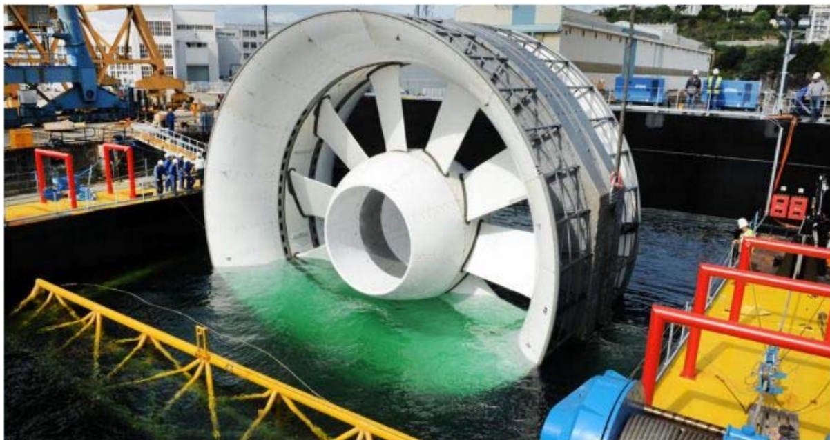
Illustration 1 : Mise à l'eau d'une hydrolienne (Crédit photo : DCNS)
